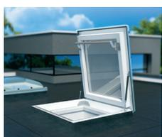
DRC – окно-люк с куполом, оборудованный антивандальным стеклопакетом P2. Купол может быть прозрачным или матовым. Окна 90x90 и 100x100 см открываются на угол до 80°, в размерах 90x120 и 120x120 см – до 60°. Газовые амортизаторы облегчают управление створкой и удерживают её в зафиксированном положении.
