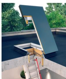
Предназначен для выхода на плоскую кровлю и её обслуживания. Обладает высокими параметрами теплоизоляции и герметичности (толщина утеплителя – 44 мм), а также устойчивостью к механическим повреждениям. Изготавливается из многокамерного профиля ПВХ и не имеет стеклопакета. Створка открывается на угол до 60° и фиксируется. Установка в кровле от 0° до 5°.
